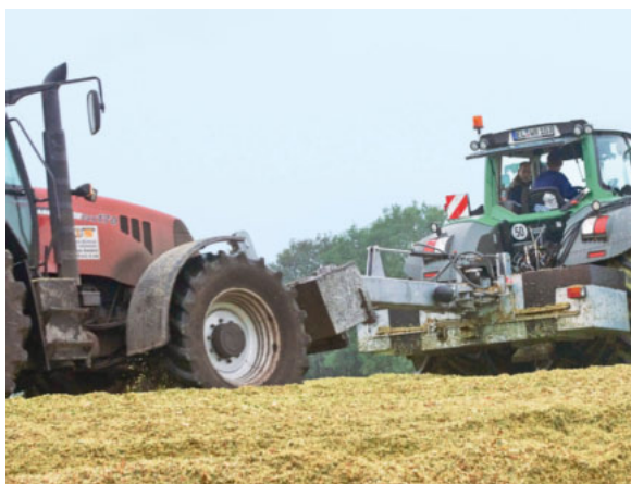
Der Clou : Am Heckgewicht des Walztreckers befindet sich ein ausziehbarer Zughaken, der genau in die Öse der Frontgewichte der Abfahrtschlepper passt.
